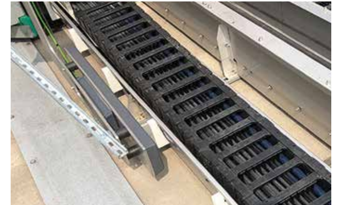
e-kette® P4.1 mit EC.PP im igus® Außenversuch
